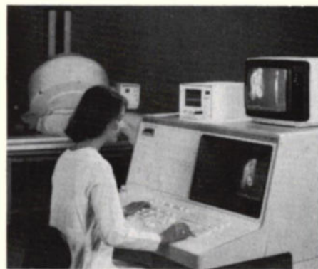
Afb. 1. De Processing en Display Unit met extra ECG- en kleurenmonitors. Op de achtergrond de gamma-camera.
