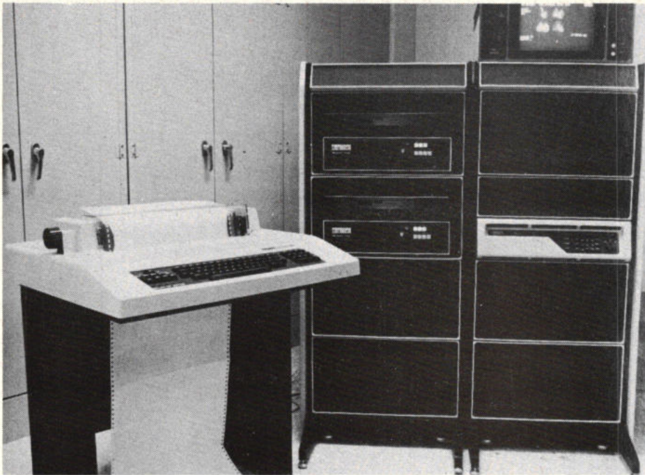
Afb. 2. Een voorbeeld van een computer zoals gebruikt wordt in de nucleaire geneeskunde. In dit geval een PDP 11/34 gamma 11 (foto Digital).
